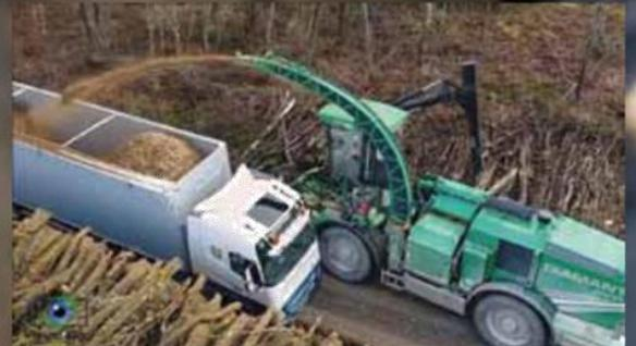
La torre de eyección, puede moverse 240° que permite un amplio rango de trabajo y gran comodidad de carga
