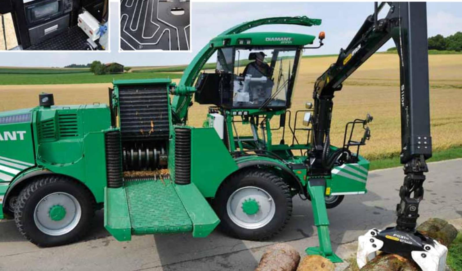
La cabina climatizada se puede elevar a una altura de 4,8 metros y de ese modo permite una visibilidad óptima para el operador. El asiento giratorio ergonómico (180 °)
