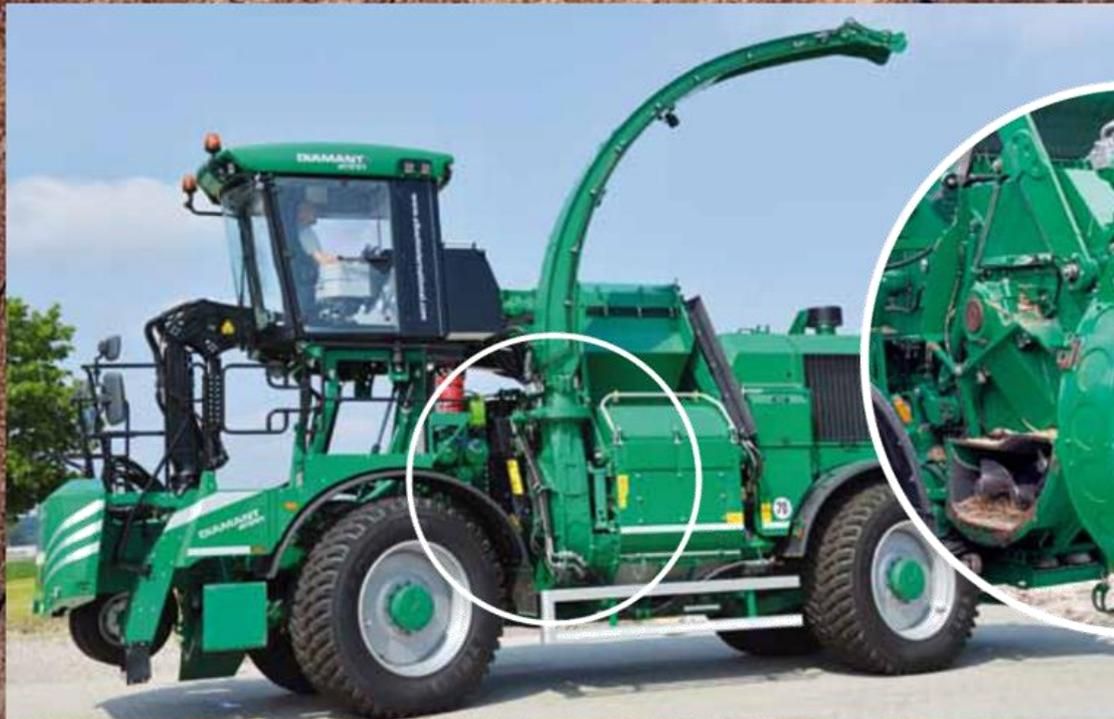
Placas de desgaste reemplazables permiten una optimización de la gran calidad de las astillas y un funcionamiento prolongado.
